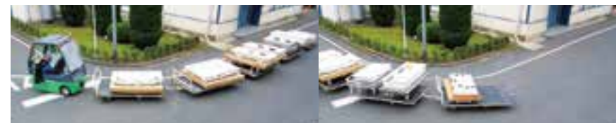
4WS台車スキッパーは、タイヤの切れ角をリンク機構で制御内外輪の旋回中心を一致させるため、台車を連ねてもほぼ同一軌跡を通過
