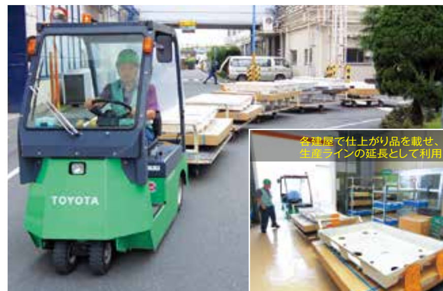
邸別の部材を台車に載せ、加工工程と出荷をつなぐ
