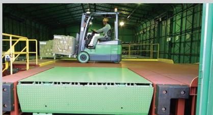
コンテナヤードで真価を発揮するジェネオE。狭いコンテナ内ではより安全な作業が要求される。OPS機能によりオペレーターが離籍した場合には動力走行を停止。壁に挟まれるなどの事故防止に貢献。
