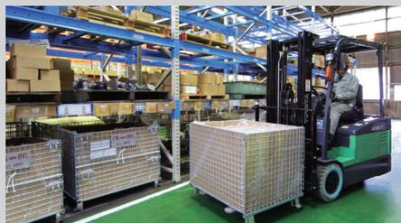
搬送される折りたたみ式のメッシュボックスパレットは使用後、まとめて中国に送られ新たな部品を積んで戻ってくるため包装材の削減、開梱作業の簡素化に貢献。
